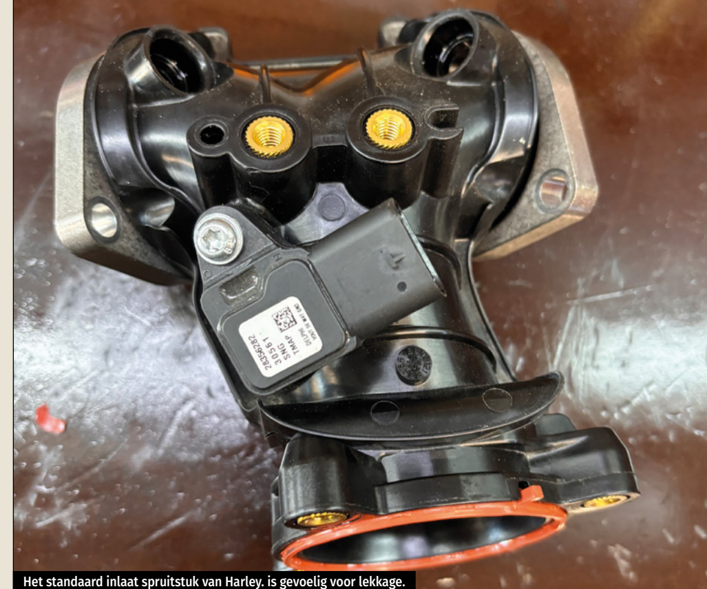
Het standaard inlaat spruitstuk van Harley, is gevoelig voor lekkage.
