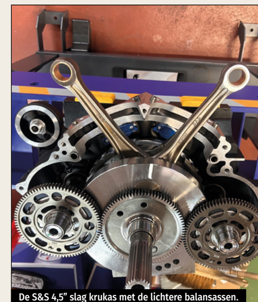
De S&S 4,5" slag krukcas met de lichtere balansassen.
