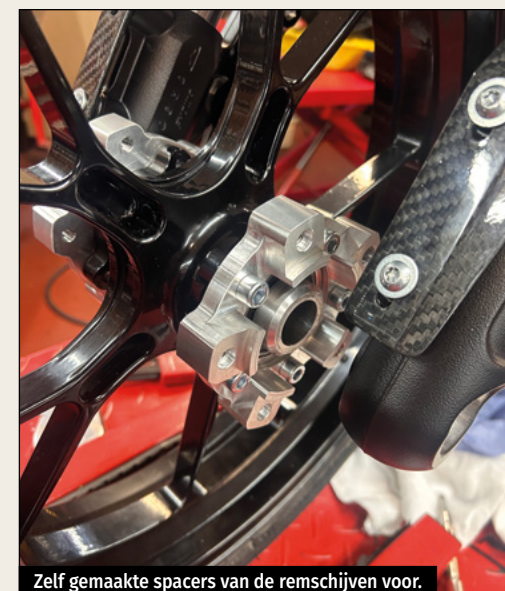
Zelf gemaakte spacers van de remschijven voor.
