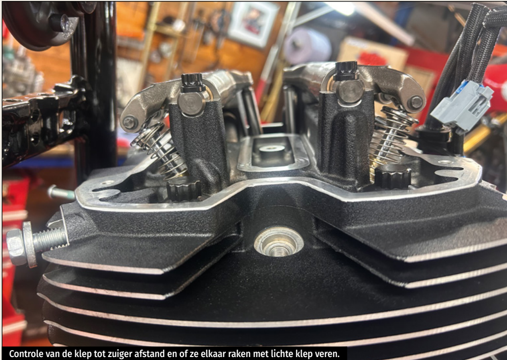
Controle van de klep tot zuiger afstand en of ze elkaar raken met lichte klep veren.
